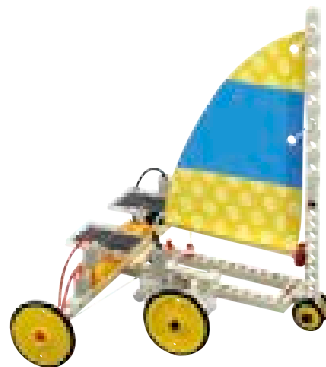
Kombi-Fahrzeug mit Solarantrieb und Segel
