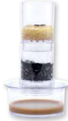
minimaler zweistufiger Filter mit Sand und Aktivkohle
